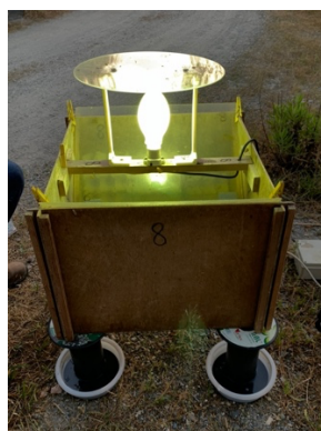
Figura 4: Trampa empleada para los censos de mariposas nocturnas. Autor: Manuel Galletero Zafra
