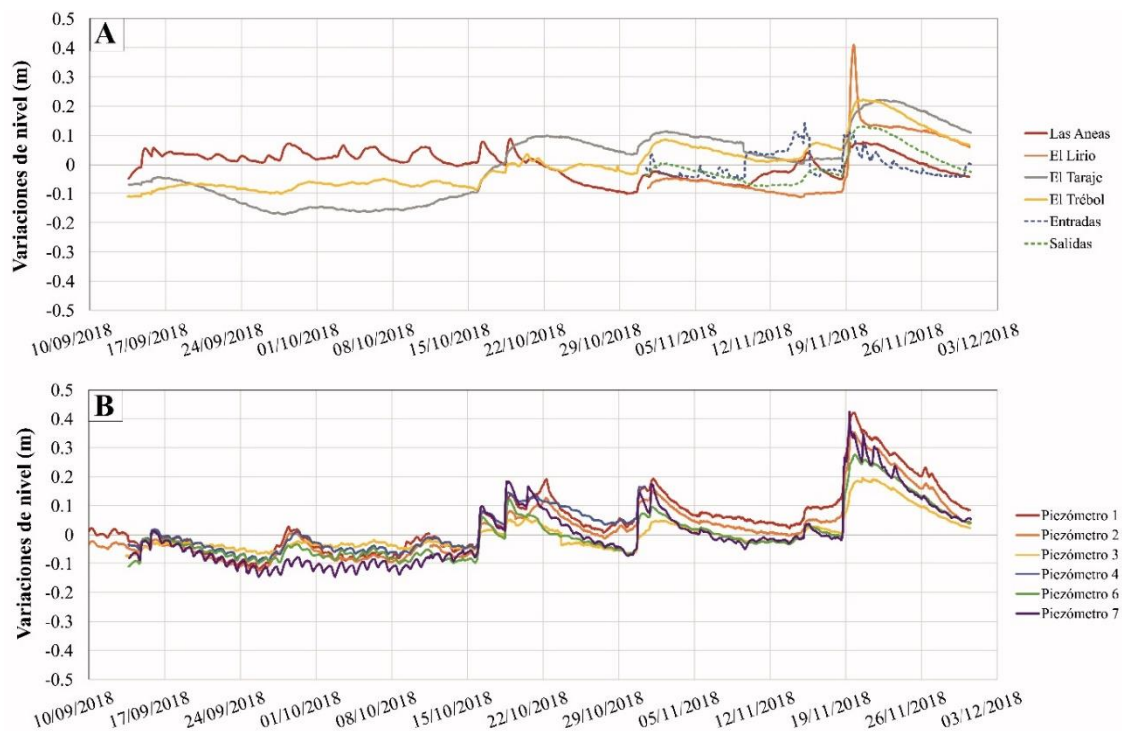
Figura 4. Series temporales recogidas por sensores en: (A) Lagunas y estaciones de aforo y (B) Piezómetros.
