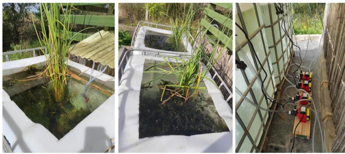
Figura 18. Sistema de Filtros biológicos (uno para cada grupo de acuarios de cada especie) y bombas del diseño de un método optimizado de obtención de alevines de fartet y pez mosquito: Experimentos de biología reproductiva de cada especie.
